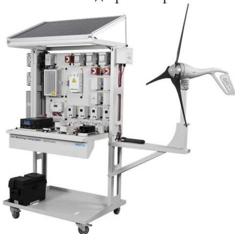
Күн / жел энергетикасын зерттеуге арналған демонстрациялық стенд-тренажер
