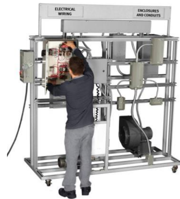
Электр сымдарын оқытудың демонстрациялық өнеркәсіптік жүйесі
